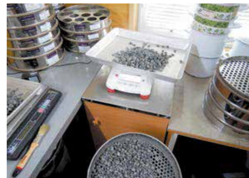
На фото Определение зернового состава щебня
